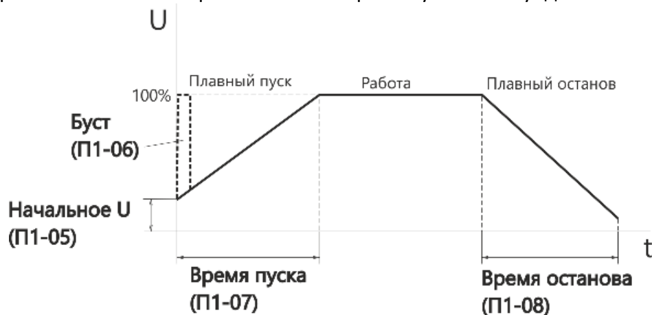
Рисунок 5 – Диаграмма плавного пуска с нарастанием напряжения и плавного останова
