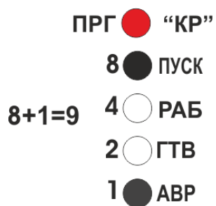
Рисунок 9 - Пример индикации значения уставки =9
